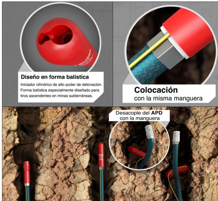
Las ventajas del diseño balístico es que facilita la colocación del Booster en pozos ascendentes a pesar de las paredes angulosas que pueda presentar el pozo. De esta manera nunca se desacopla de la manguera y tiene menor tiempo de primado asociado.
