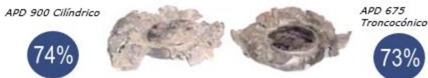
Los resultados mostrados determinan que las performances entre ambos productos son muy similares, incluso en medición de VOD el 675 tiene mejor desempeño. Esto es debido a la forma troncocónica permite direccionar la energía hacia un punto en particular, se consigue el efecto Monroe.
