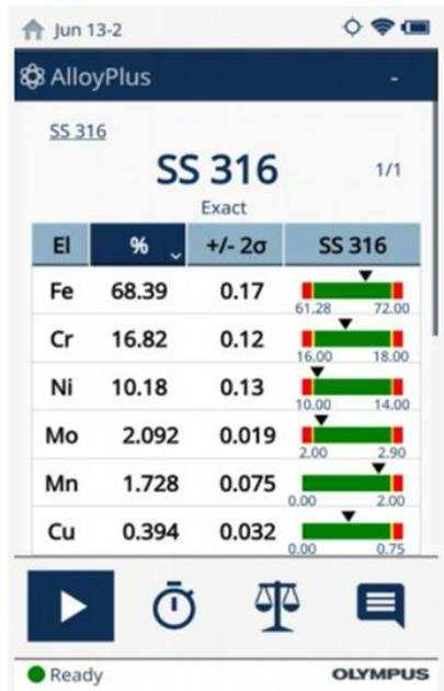
**Figura 34:** Interfaz equipo pXRF VANTA con resultados de análisis geoquímicos.
