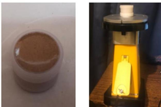
**Figura 33:** Sellado y análisis de muestras en equipo pXRF.
