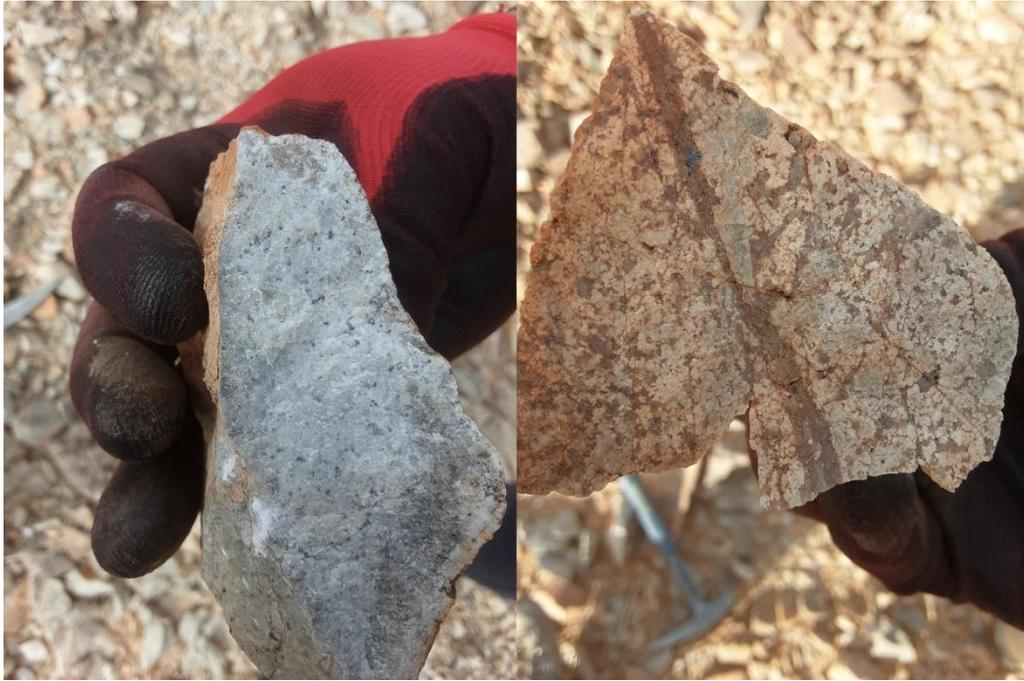
**Figura 48:** (a) Pórfido riodacítico con textura levemente afanítica y feldespatos tabulares junto con fenocristales de cuarzo en una masa fundamental silíceo-feldespática. (b) Ojos de cuarzo junto con vetillas subparalelas de cuarzo.
