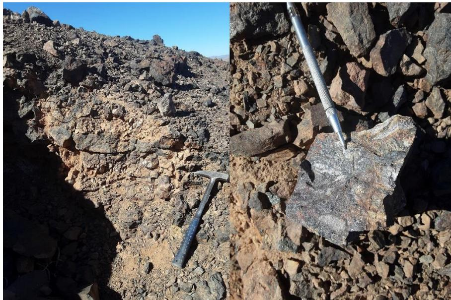
**Figura 63:** (a) Pique exhibiendo estructura de hematita-especularita-sílice. (b) Brecha Riodacítica de Sílice-Hematita, se observan fragmentos angulosos de rocas dioríticas.
