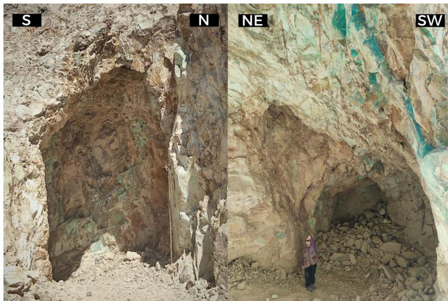
Figura 33.- Rajo de dimensiones menores realizado para la búsqueda de óxidos de cobre. Se observa una baja ley asociada a crisocola por lo que se desistió de su continuación. Se observa una pérdida de continuidad en la mineralización debido a la presencia de una falla que corta su desarrollo.
