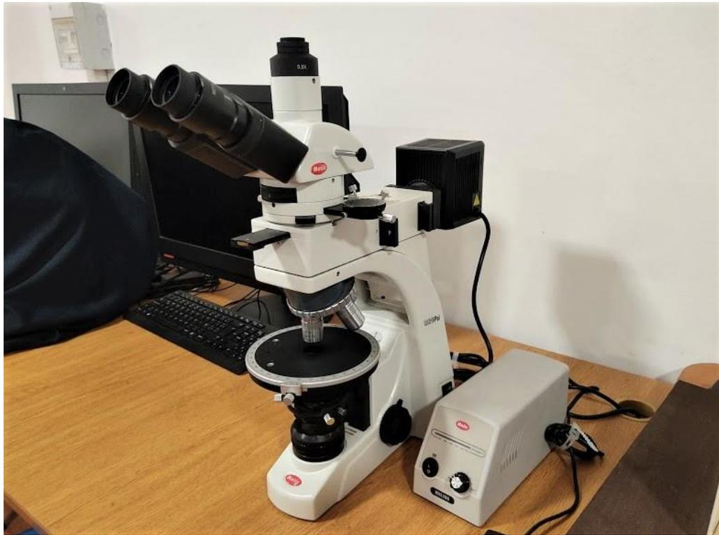
Figura 10 Microscopio petrográfico modelo MOTIC BA310 POL+EPI trinocular
