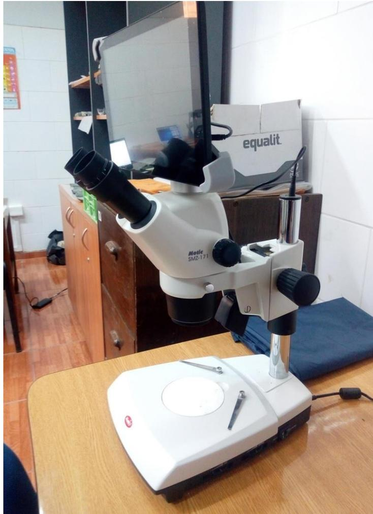
Figura 6.- Lupa binocular marca Motic, modelo SMZ-171 (elaboración propia).
