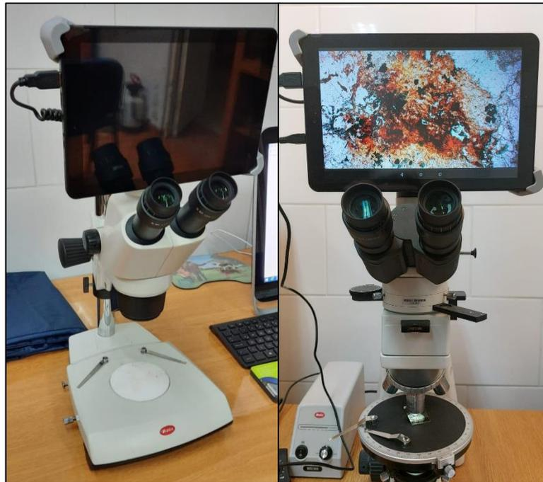
Figura 14: Lupa binocular marca Motic, diseño SMZ-171 (izquierda) y Microscopio marca Motic (derecha)
