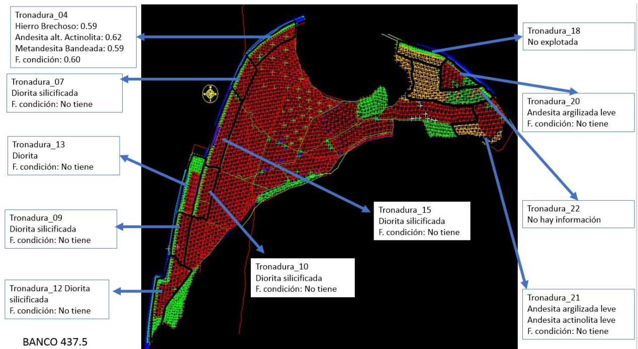
Figura 7.8- Tronaduras de contorno pertenecientes al Banco 437.5.
