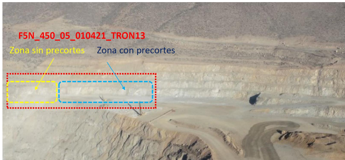
Figura 6.58- Tronadura 13 que muestra zona sin y con pre-cortes.
