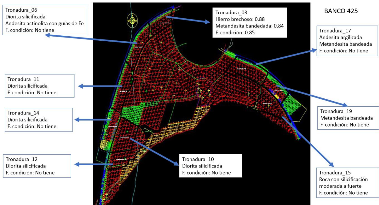
Figura 7.9- Tronaduras de contorno pertenecientes al Banco 425 indicando la litología correspondiente a cada polígono.
