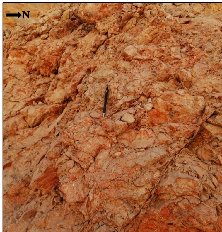
Figura 4.4. Acercamiento de dique de guijarro ubicado en el nivel 1115 m.s.n.m. mostrando fragmentos subredondeados a subangulosos de caliza y microdiorita, inmersos en una matriz fina de óxidos e hidróxidos de hierro.
