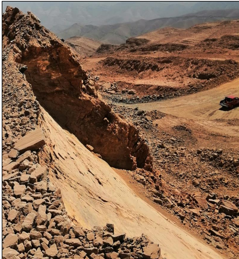
Figura 5.2. Plano de estratificación fisible de la unidad Caliza Superior deslizado en el nivel 1105 m.s.n.m.
