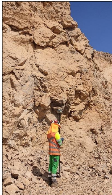
Figura 3.2. Levantamiento de puntos topográficos de las estaciones de mapeo en terreno mediante GPS Stonex S9III Plus.
