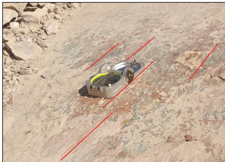
Figura 5.1. Plano con estrías (líneas de color rojo), perpendiculares al rumbo NNW – SSE de la estratificación con dato estructural de la estría equivalente a 196/89L.
