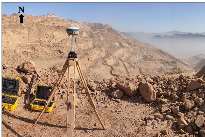
Figura 3.1. Equipo topográfico GPS Stonex S9III Plus instalado en Cantera Normal.
