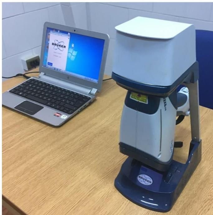
**Figura 21:** Equipo portátil de Fluorescencia de rayos X (XRF) modelo S1 TITAN Bruker, Laboratorio del Núcleo de Investigación de Cobalto y Tierras Raras, Universidad de Atacama (Fuente: Edición Propia).
