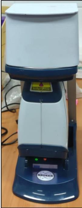
**FIGURA N°15.** *Analizador XRF. Fotografía tomada durante la investigación*
