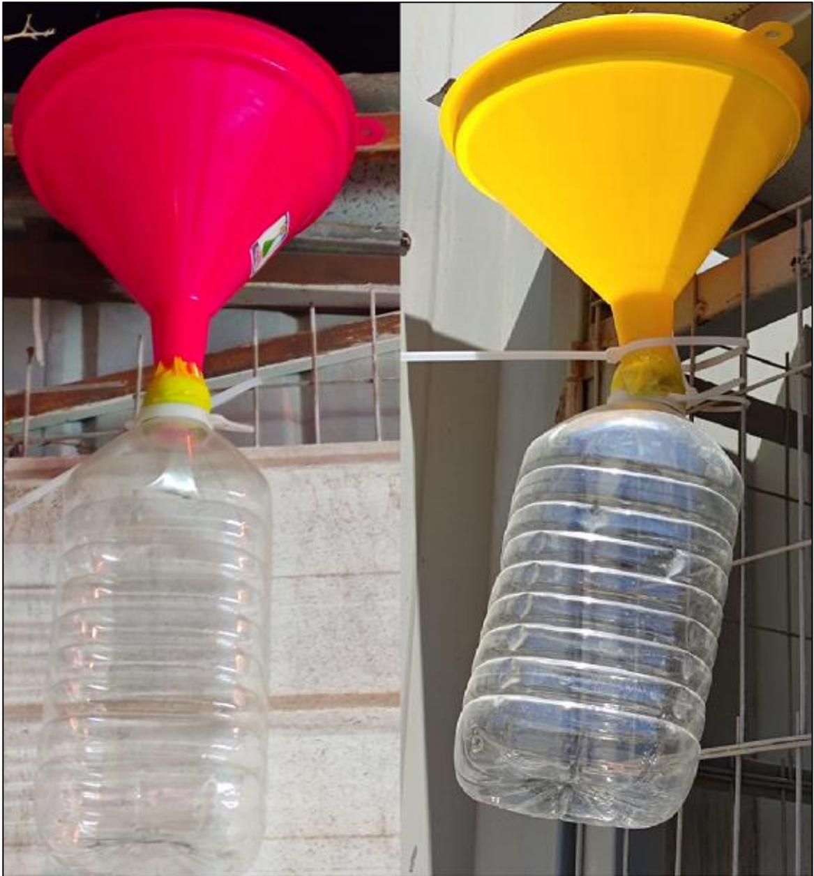
**FIGURA N°14.** *Contenedores instalados, de tal forma que los sedimentos caen libremente en la parte superior, son filtrados para llegar a la bolsa final. Fotografía de terreno.*
