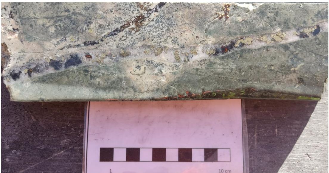
Figura 15: Fotografía de andesita con textura afanítica. La roca se compone de masa fundamental alterada a sericita-clorita con intensidad moderada y en menor proporción una alteración cuarzo-sericita
