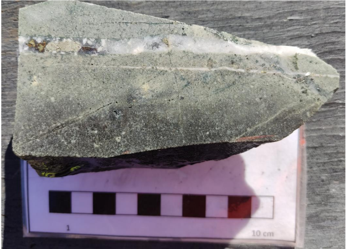
Figura 14: Fotografía de andesita con textura porfídica. La roca se compone de una masa fundamental afanítica con alteración cuarzo-sericita de intensidad moderada. También se observa una alteración secundaria potásica-biotita con intensidad moderada. Presenta fenocristales de plagioclasas de 0.3cm a 0.2cm de espesor alterados por sericita con intensidad moderada. En cuanto a la mineralización se logra reconocer diseminación de sulfuros, en este caso pirita en mayor proporción que la calcopirita, ambos minerales se logran apreciar de tamaño fino en la roca. La muestra presenta una vetilla de aproximadamente 1 cm de espesor la cual se compone de cuarzo-pirita-calcopirita, ordenadas de mayor a menor abundancia en la vetilla.
