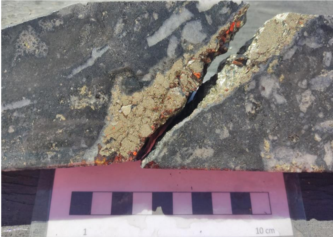
Figura 41: Fotografía de brecha hidrotermal oligomíctica, matriz soportada, con matriz de turmalina. Se logra observar una vetilla gruesa de pirita euhedral de 2.3 cm de potencia aproximada, la cual también contiene cristales de cuarzo y calcopirita, pero estos dos en considerable menor proporción.
