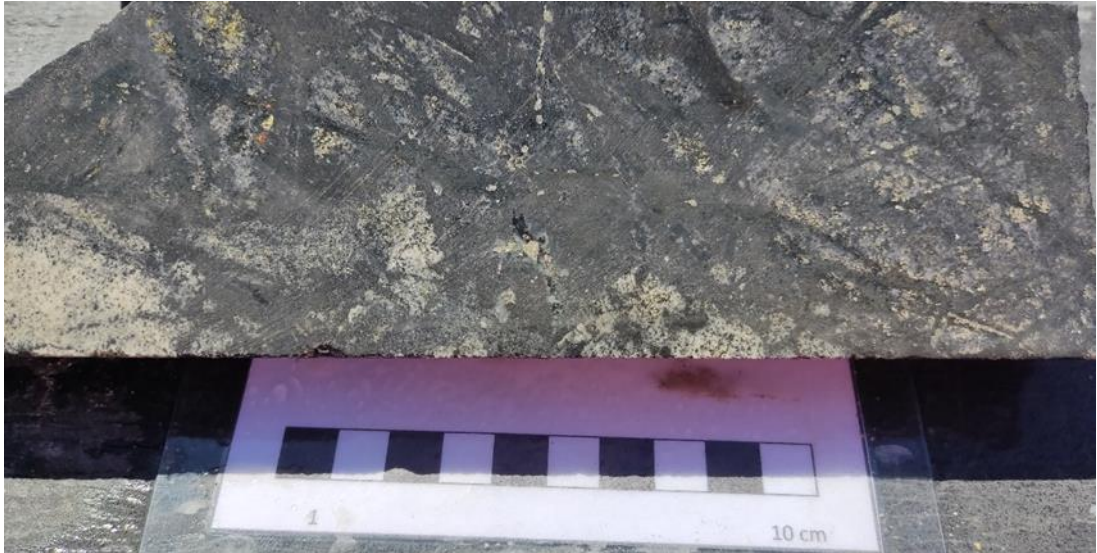
Figura 34: Brecha hidrotermal de turmalina, matriz soportada, de composición monomítica. Los clastos corresponden a pórfidos feldespáticos con alteración cuarzo-sericita en intensidad leve a moderada. Se observa mineralización de tipo sulfurada de grano fino en un modo de ocurrencia diseminado, tanto de pirita como calcopirita. Esta mineralización ocurre en los clastos de pórfido como en la matriz, siendo esta última en donde es mayor la abundancia de estos minerales.
