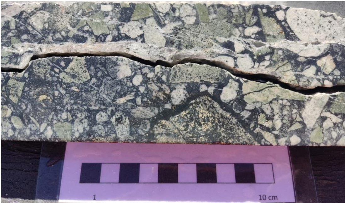
Figura 32: Fotografía de brecha oligomítica de turmalina, se puede observar en la parte superior derecha de la muestra una falla local que desplaza algunos clastos de pórfido como también de andesita, por lo que se interpreta que esta falla ocurrió posterior al emplazamiento de la brecha, y que también en un evento posterior fue reutilizada por fluidos rico que depositaron yeso.
