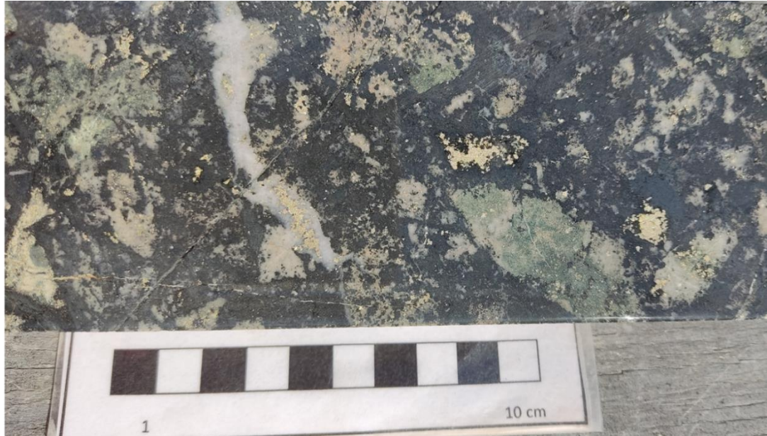
Figura 26: Fotografía de brecha hidrotermal polimíctica, matriz soportada, se observa mineralización sulfurada de grano grueso de calcopirita y pirita en la matriz de turmalina, mientras que en los clastos de andesita se observa mineralización de grano fino de pirita en mayor proporción que calcopirita, caso contrario para los clastos de cuarzo que presenta mineralización de grano grueso, mayoritariamente de calcopirita.
