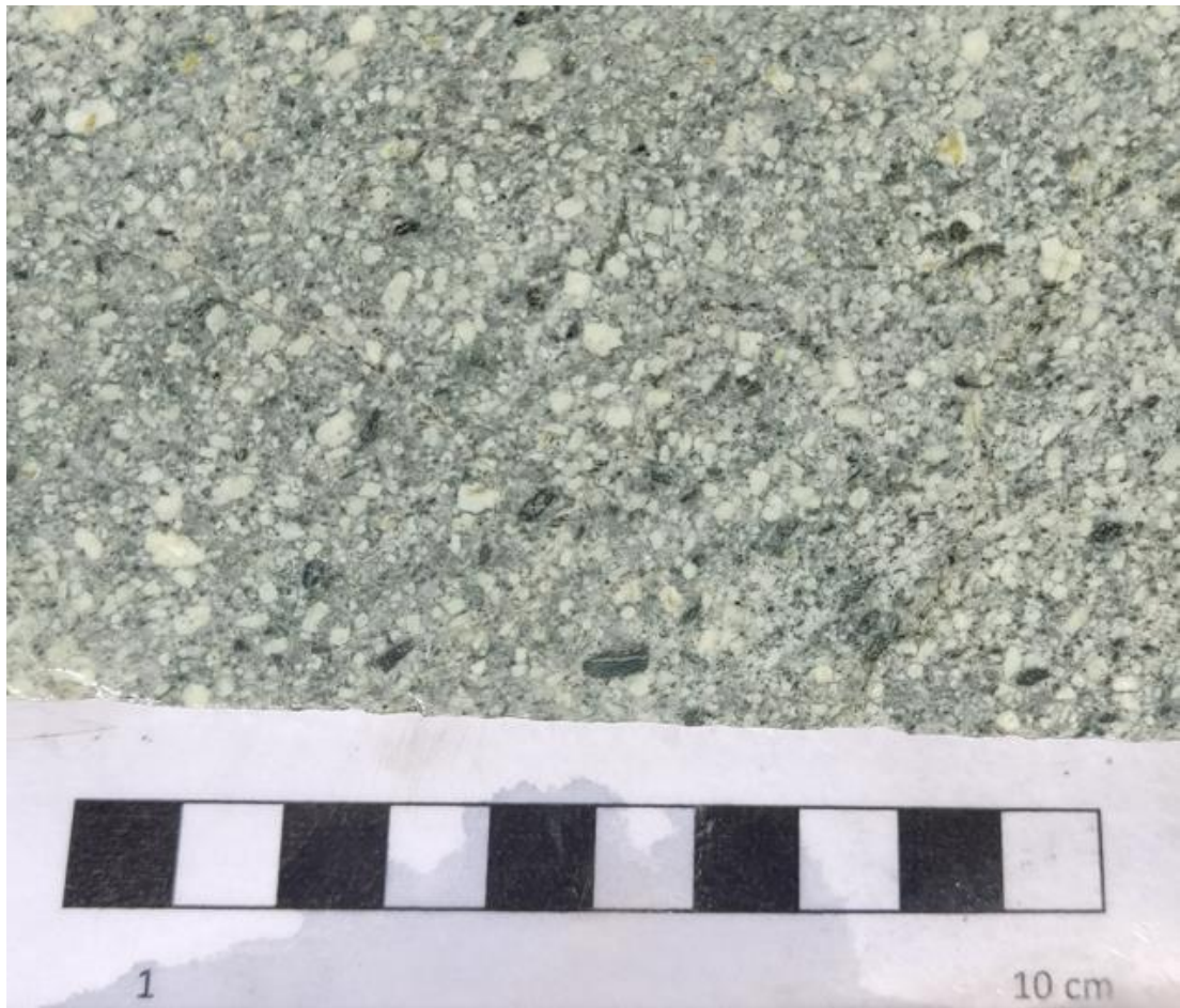
Figura 18: Fotografía de pórfido granodiorítico con textura porfídica y holocristalina, tanto los fenocristales como la masa fundamental de feldespatos presentan una alteración moderada de sericita-clorita.
