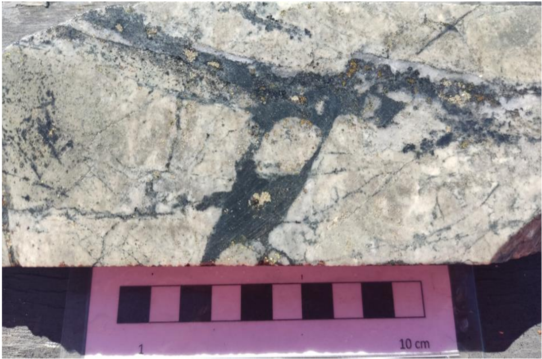
Figura 42: Fotografía de brecha hidrotermal polimíctica, matriz soportada, con composición de matriz de turmalina. Se observa mineralización diseminada de pirita y calcopirita de tamaño fino en los clastos de pórfido, siendo la pirita la de mayor abundancia en este tipo de clastos. En el caso de los clastos de cuarzo se observa el mismo tipo de mineralización, pero en menor proporción. En la matriz se observa una mineralización diseminada de tamaño fino de calcopirita y pirita, estando las dos en la misma proporción aproximadamente.
