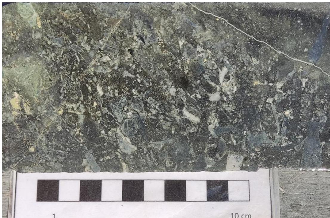
Figura 27: Fotografía de brecha hidrotermal polimíctica matriz soportada, se logran observar clastos angulosos a sub angulosos de cuarzo, los cuales se infiere que provienen de vetillas emplazadas en un evento anterior a la formación de la brecha. En cuanto a la mineralización, se logra reconocer precipitación de sulfuros de grano fino, con mayor proporción de pirita respecto a calcopirita, tanto de manera diseminada en la matriz como en los clastos. En comparación con la figura 26, se observa que la mineralización en este tramo es de considerable menor proporción.
