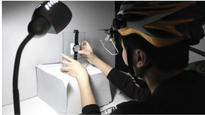
Figura 3.9: Configuración de la estación de trabajo para realizar una prueba de usabilidad de un *smartwatch* empleando *eye tracking* [Wu *et al.*, 2016].
