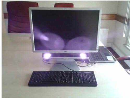
Figura 2.2: Ejemplo de una configuración de un dispositivo de *eye tracking* de la marca SMI modelo iView X ubicado debajo de la pantalla de un computador [Mutlu-Bayraktar, 2017].
