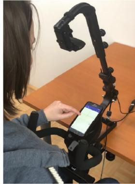
Figura 2.1: Ejemplo de una configuración de un dispositivo de *eye tracking* de la marca Tobii Pro modelo X2-60 [Tomaschko y Hohenwarter, 2018].
