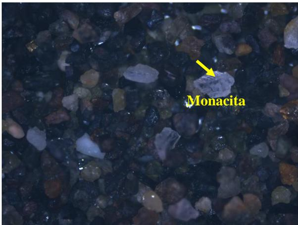
Figura N° 4. 43 No conductor magnético.
