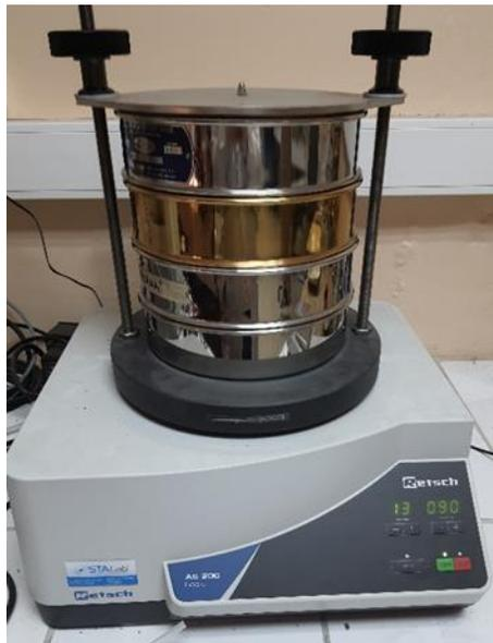
**Figura N° 3. 1 Series de tamices en el ro-tap, modelo AS 200.**
