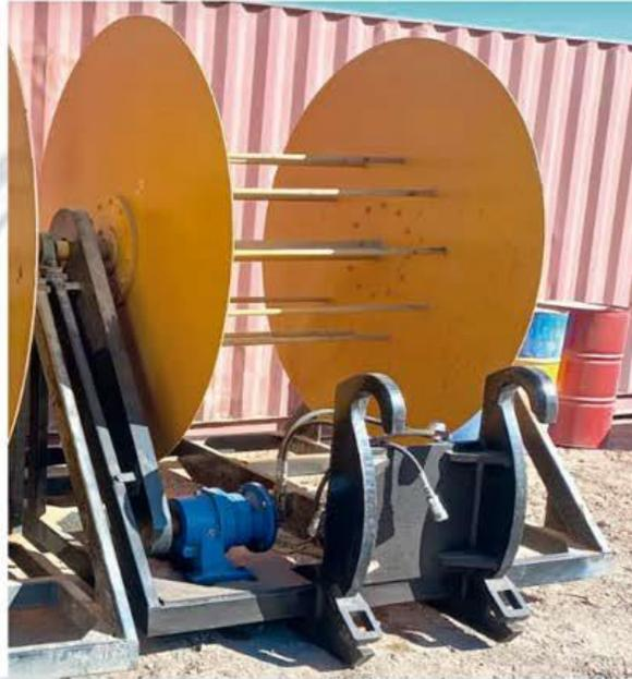
*Imagen n°1. Vista general del componente, inspección realizada mediante particulado magnético líquido, No se detectan fisuras ni grietas en todo el componente, se acepta calidad de acuerdo con normativa ASME.*
