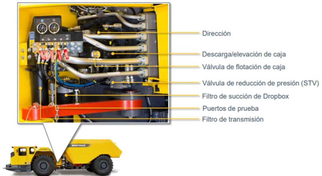
Figura N° 3.11: Cuerpo de válvula principal VMC, camión MT-65 EPIROC.
