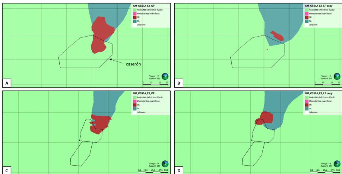
Figura 52: En A y C, se muestra el modelo geológico a corto plazo, en B y D se ve el modelo geológico a largo plazo. El caserón se ve como una línea negra entre los contactos litológicos, siendo señalada con una flecha en A. En la leyenda TA (Tobas de Agustina) y SR (Sedimentos Rojos).
