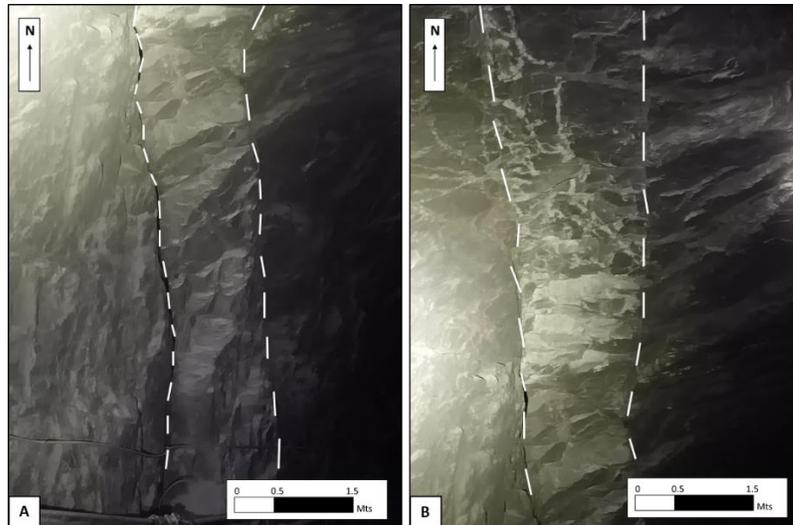
Figura 16: Fotografías que muestran los dos diques presentes. En A se ve el dique de NP-3S y CZ-6. En B el dique en la labor NP-2.
