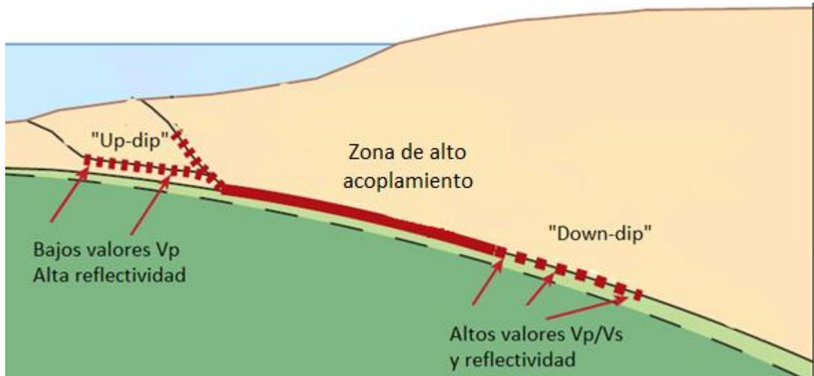
Figura 2.3. Modelo conceptual donde se muestran las variaciones relativas esperadas en velocidad sísmica y reflectividad sísmica en las zonas de transición del *megathrust*. Modificado de Saffer y Tobin (2011).
