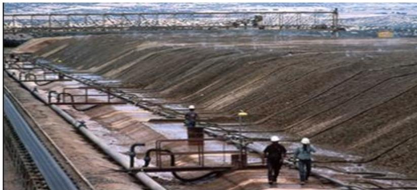
**Figura 2.5. Pilas de lixiviación**
