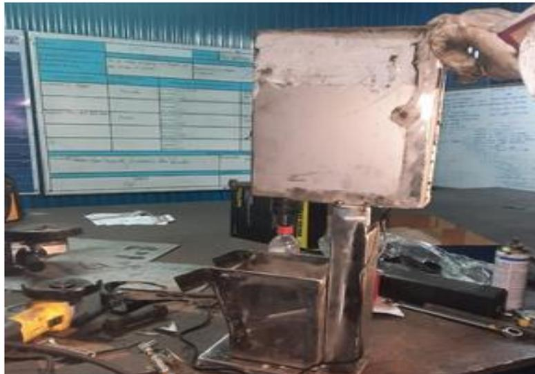
**Figura 4.4 Fabricación de pedestal de motor**
