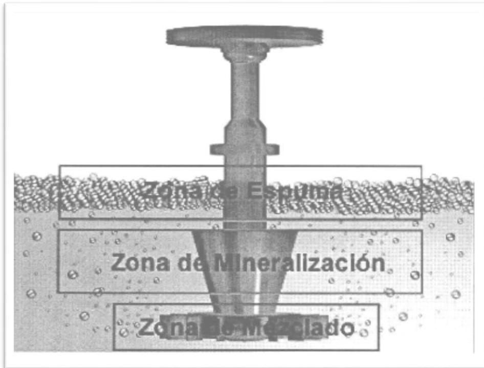
**Figura 2.24 Zonas de la Flotación**
