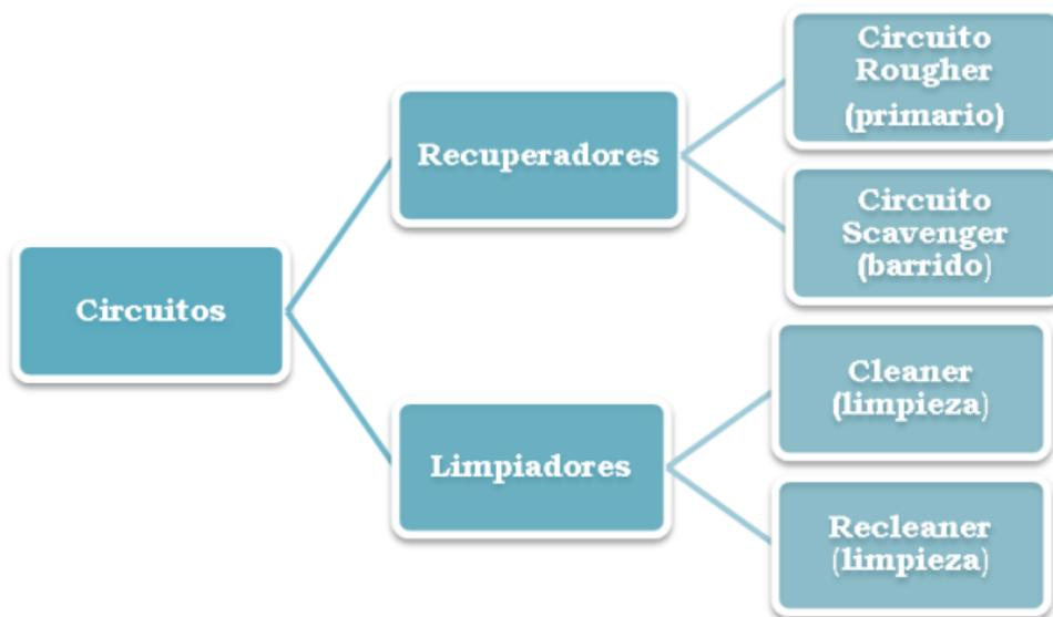
Figura 2.32. Circuito de las etapas de Flotación
