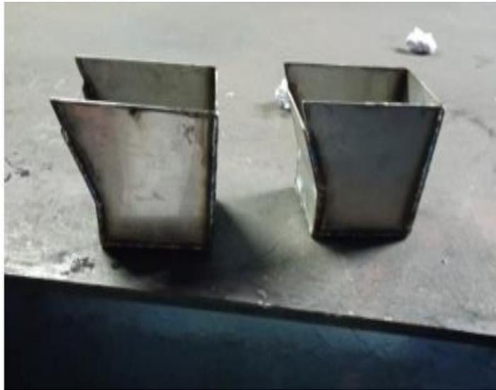
**Figura 4.2 Unión y armado de estanque**
