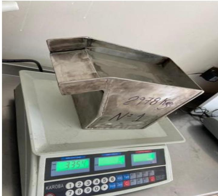
**Figura 3.23. Estanque con Rebalse**
