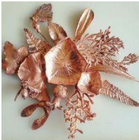
**Figura 2.10. Piezas elaboradas por electroconformado de cobre**
