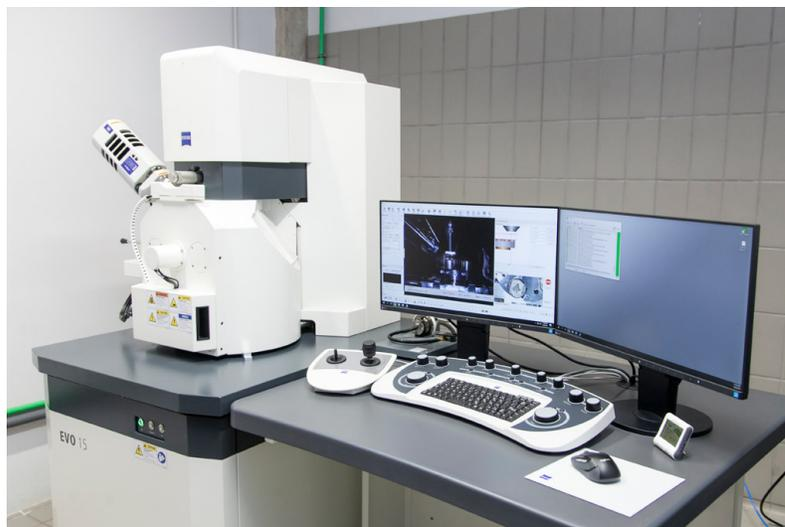
**Figura 2.22: Microscopio electrónico de barrido.**
