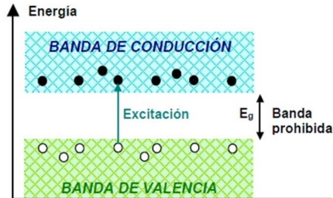
Figura 2.3: Representación de las bandas de un material.
