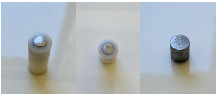
Figura 3.4 Electrodo de trabajo de acero al carbono tipo AISI 1020.
