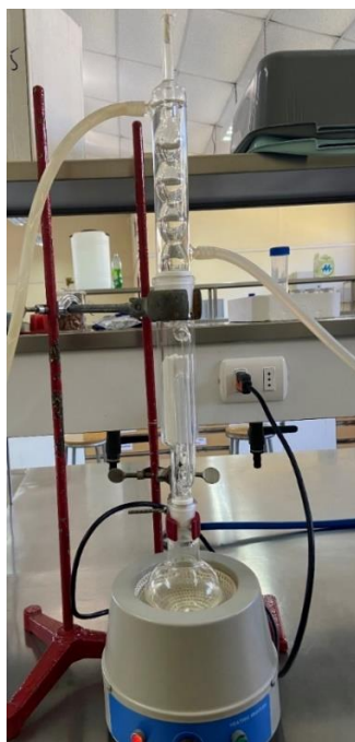
Figura 3.1 Extracción acuosa en extractor Soxhlet.
