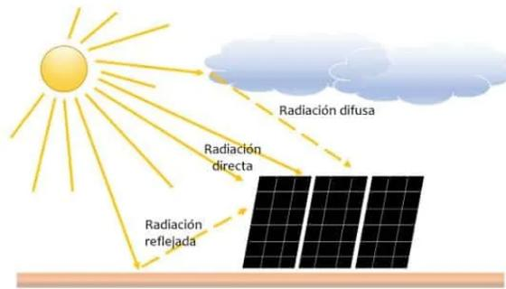
**Figura N° 2.3: Formas de Radiación Solar.**
